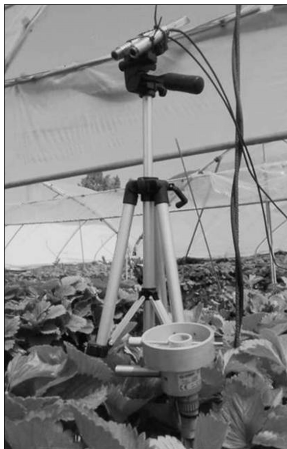
Fig. 3 - Sensori di temperature IR e di bagnatura fogliare. Fig. 3 - Ir temperature sensor and leaf wetness sensor.
