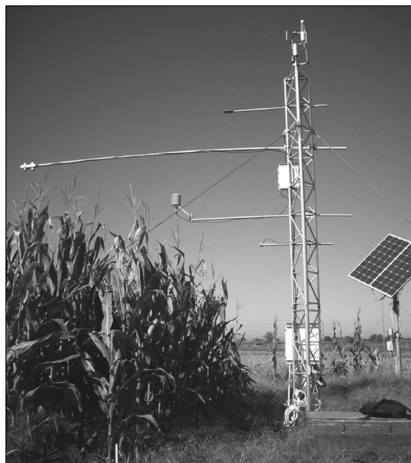
Fig. 2 - La stazione eddy covariance di Livraga (LO). Fig. 2 - Eddy covariance station of Livraga (LO).
